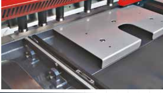
■ Parmak Koruma, Bilya Taneli Sac Sürme Plakaları, Baskı Silindirleri
